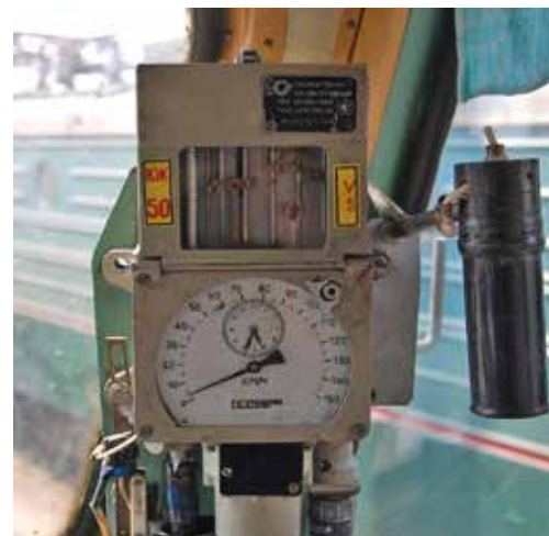
Рис. 1. Механічний швидкостемір ЗСЛ-2М
